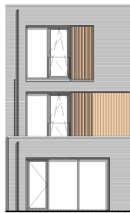
Optie uitbouw 2400mm bouwnummer 69 t/m 76 Achtergevel
